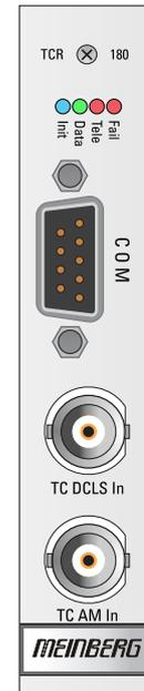
DC Level Shift Eingang - isoliert durch Optokoppler mit internem Reihenwiderstand von 220 Ω.
