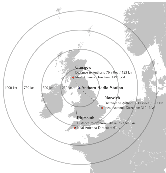
Abbildung: Ausrichtung einer AW02-60-Antenne von verschiedenen Standorten aus in Großbritannien auf den MSF-Sendeturm in Anthorn.
