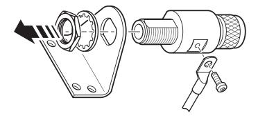
Abb. 7: Montage des Überspannungsschutzes
