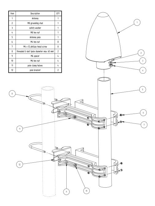
Abb. 3: Mastmontage einer Meinberg GPS-Antenne
