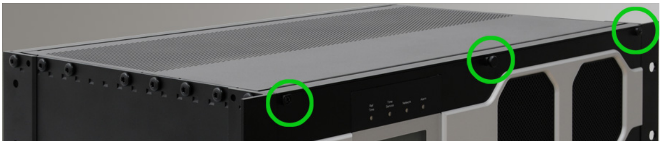
Abb. 1: Lösen der Befestigungsschrauben der Frontplatte
